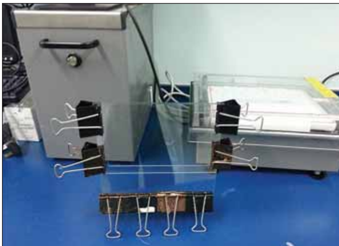
Obr. 2. Elektroforetická zostava pre manuálnu metódu (vlastné údaje).
