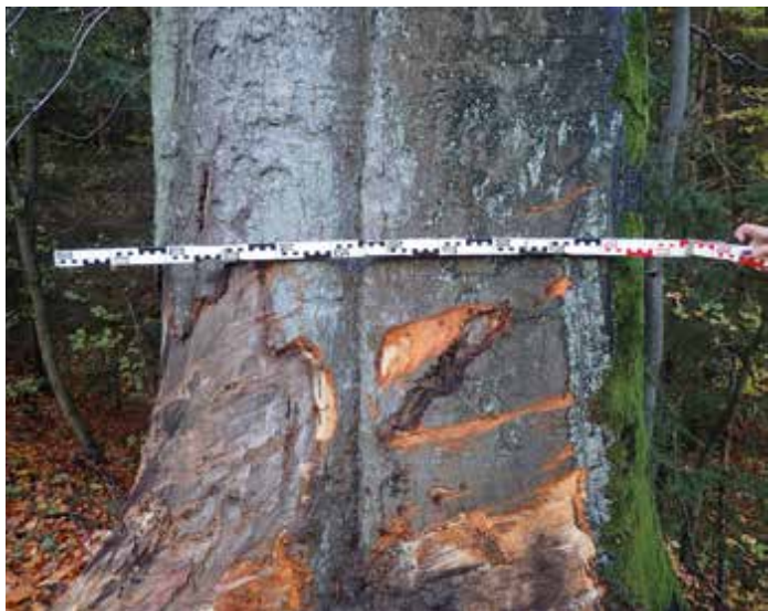
Obr. 6. Stopy po kontaktu s vozidlem č. 2 zanechané na stromě. Fig. 6. Marks left on a tree after contact with vehicle no. 2.
