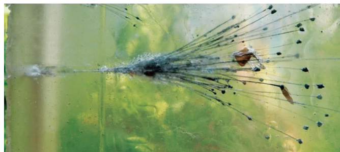
Obr. 7. Účinek pistolové frangible střely Extreme Shock AFR na transparentní substituci (ve vějíři wolframových částic jsou navíc i střepiny z pláště).
