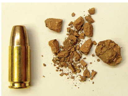
Obr. 3. Charakteristický rozklad 9 mm pistolové frangible střely (na bázi Cu) na pevné překážce (vlevo náboj před výstřelem).
