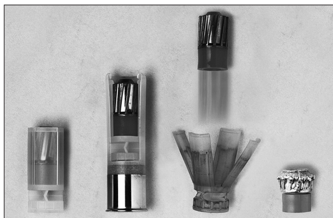
Obr. 4. Podkaliberní střela Brenneke RubinSabot (Brenneke®). Zleva doprava: střela v plastovém obalu, střela s pouzdrém v nábojnici, střela krátce po opuštění hlavně a deformace střely při zásahu cíle
