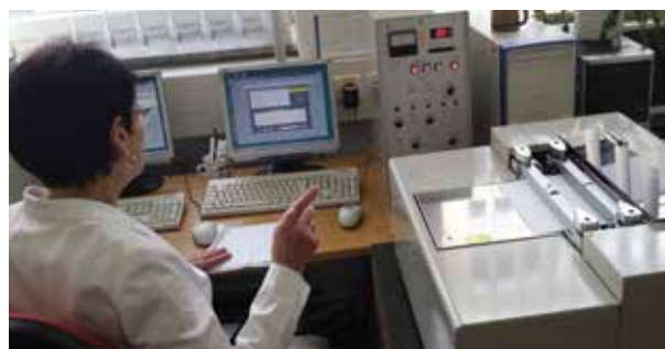
Obr. 1. Přístroj podle Kawabaty ke zjišťování některých fyzikálních vlastností plošných textilií (senzoričský komfort)
