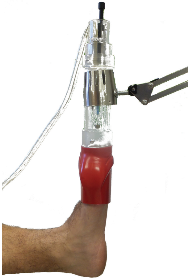
Obr. 2. Fotografie přístroje při expozici postižené končetiny nízkoteplotním plazmatem Zdroj plazmatu, schematicky znázorněný na obrázku 1, je uzavřen v plexisklovém pouzdře a upevněn v teleskopickém držáku. Prsty exponované nohy jsou uzavřeny v plastovém obalu.
