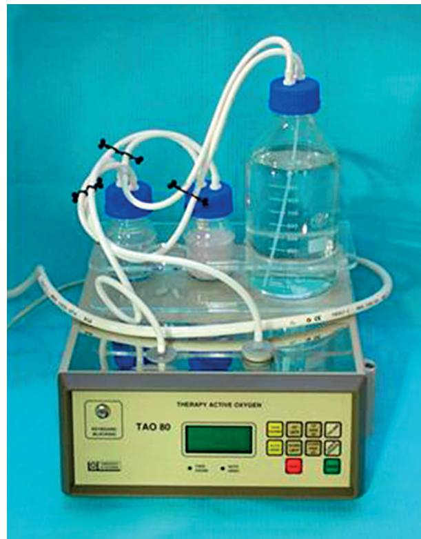
Obr. 1 Ozonizátor TAO 80 pro přípravu ozónované vody
