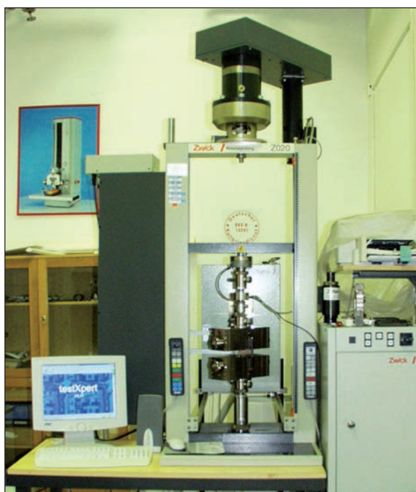
Obr. 2 Zkušební stroj ZWICK Z020 typ OK – 6423; snímač síly: 2,5 kN, rychlost tahu: 2 mm/min
