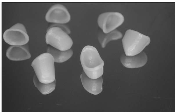
Obr. 1 Keramická jádra Procera ® Al_2O_3
