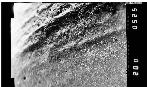
Obr. 5 Povrch keramického jádra In-Ceram® Alumina
