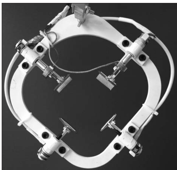
Obr. 2. Prototyp dvouosého extenzometru.
