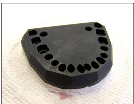
Obr. 2. Izolace kruhové základny papírem.
