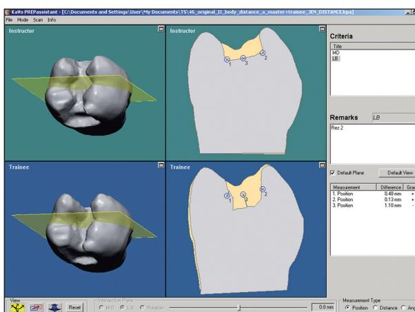
**Obr. 7.** Hodnocení pomocí rozdílu pozice bodů na okraji vzorové a zkoumané preparace. Pozor, i zde lze brát v úvahu pouze střední bod (č. 3). Z tabulky hodnocení jinak vychází, že v bodech 1 a 2 je jen malý rozdíl, což neodpovídá skutečnosti.
