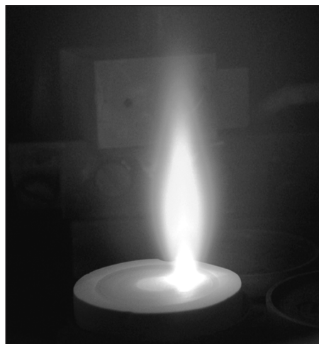
Obr. 2 Obláček plazmy ve tvaru kapky vystupující z HA terče směrem na titanový substrát.
