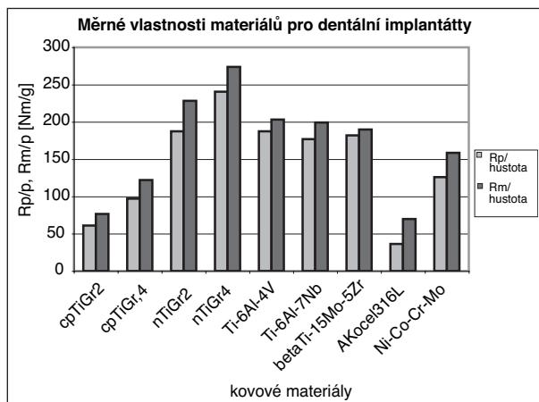
**Graf 5. Mechanické vlastnosti materiálů pro dentální implantáty vztažené k hustotě materiálu.**
