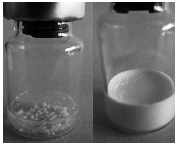
Obr. 1. Zrútený (vľavo) a vzhľadovo vyhovujúci lyofilizát (vpravo)
