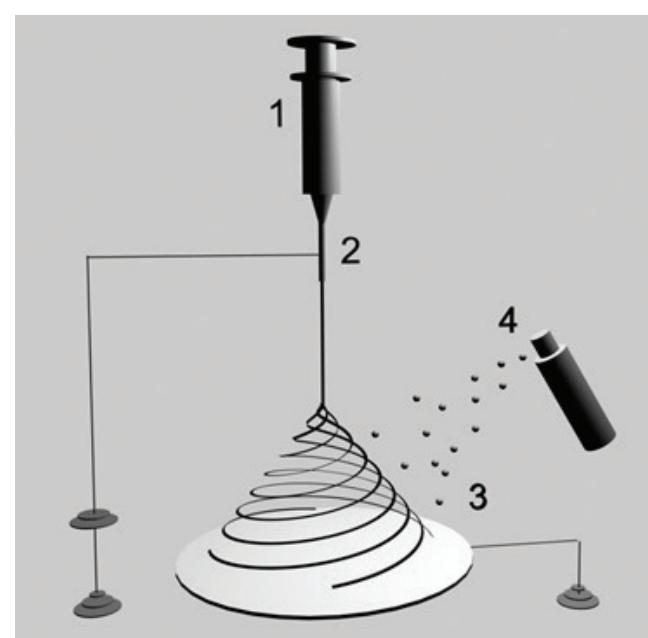
**Obr. 1** Elektrostatické zvlákňování bylo prováděno v laminárním boxu kvůli zajištění sterilních podmínek. Polymerní roztok byl umístěn ve stříkačce (1) s kladně nabíjenou jehlou (2). Vznikající nanovlákná byla sbírána na uzemněný kolektor (3). Suspenze trombocytů (4) byla sprejována mezi vznikající nanovlákná v 5minutových intervalech během celého procesu zvlákňování.
