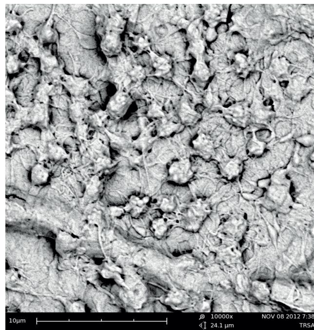
**Obr. 2** Trombocyty adherované na povrch nanovlákenné PCL vrstvy (zvětšení 10 000x).
