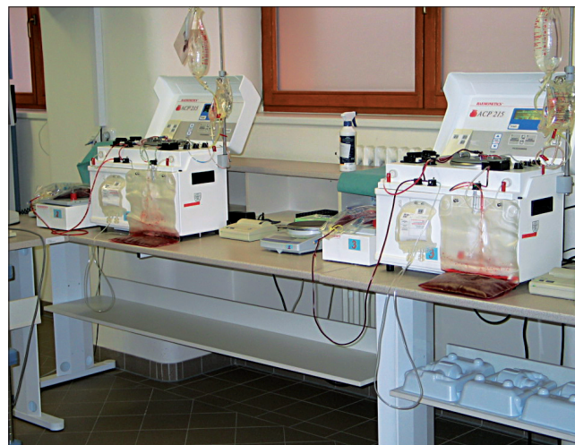
Obr. 2. Haemonetics APC-215, plně automatizované zařízení na glycerolizaci a deglycerolizaci, pracující v režimu "uzavřeného systému".
