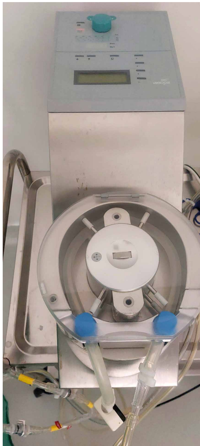
Obr. 1. Válečkové čerpadlo Sorin Stöcker S3.
