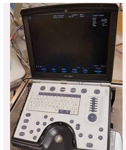
Obr. 1. Přenosný echokardiografický přístroj Vivid-i (GE Healthcare, Inc., USA).
