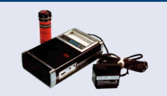
Obr | Glukomer Ames Eyetone s prúžkami Dextrostix. Upravené podľa [3]
