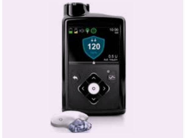
Obr. 3 | Prvý systém s automatickým dávkovaním bazálneho inzulínu na základe merania glukózy CGM systémom (Medtronic MiniMed 670G). Automatické dávkovanie je možné iba pre bazálny inzulín, kým bôlusový inzulín si podáva pacient sám (tzv. hybridný systém)
