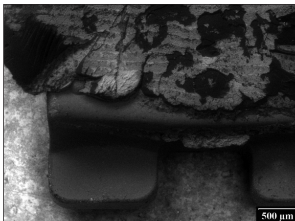
Obr. 4. Keramický ortodontický zámek po sejmutí bez známek poškození se zbytky tmelícího materiálu v elektronovém rastrovacím mikroskopu.
