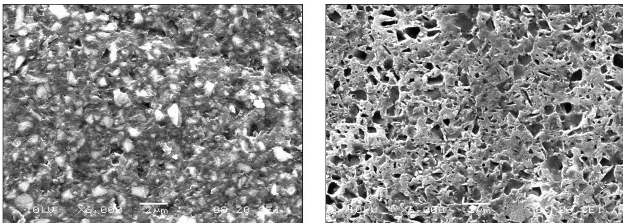
Obr. 3. Povrch kompozitního materiálu a) 2 měsících expozice v destilované vodě, b) po 25 aplikacích bělicího gelu.
