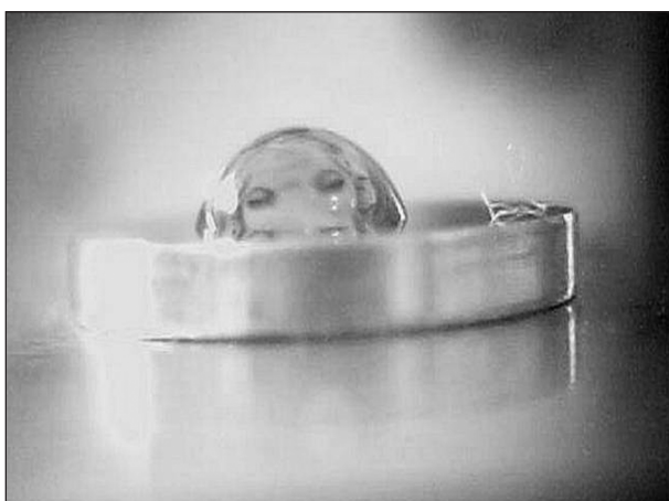
Obr. 3. Fotografie kapky destilované vody o objemu 10 µl před měřením kontaktního úhlu na vzorku titanové slitiny.
