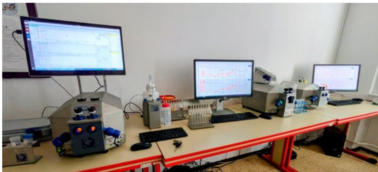
Obr. 3 Vysokoučinné oxygrafy Oroboros-2k s příslušenstvím
